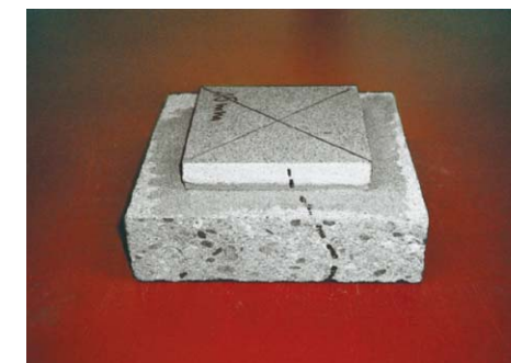
Fliese 15 mm auf Betonplatte Bruch der Platte einschließlich Fliese bei 37.800 N (Mittelwert)
